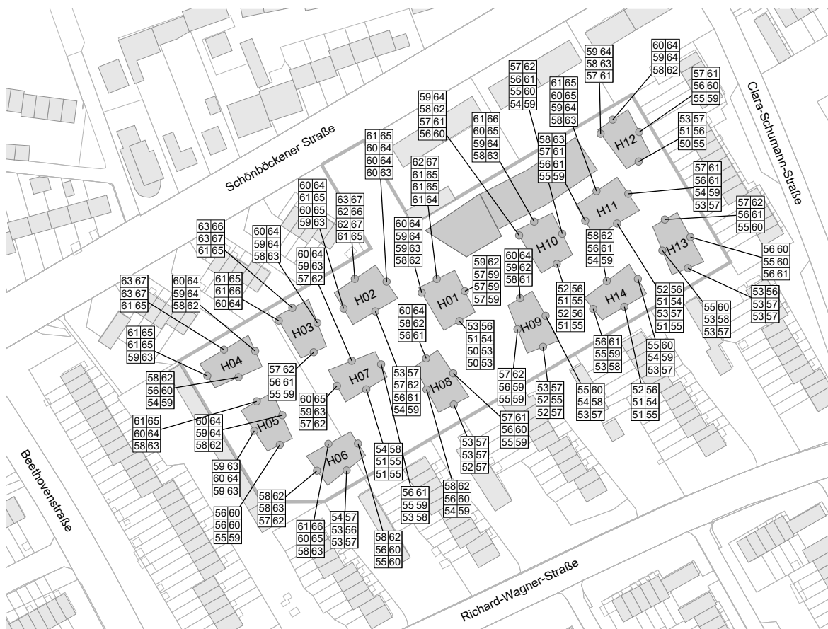
Nebenzeichnung mit maßgeblichen Außenlärmpegeln gemäß DIN 4109:2018-01 (Außenlärmpegel Tag: linke Spalte, Außenlärmpegel Nacht: rechte Spalte)
